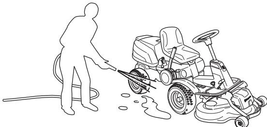
**SVARĪGI!** Pirms apkopes darbu veikšanas vienmēr novietojiet mašīnu stāvēšanai uz līdzzenas virsmas un izslēdziet motoru.
